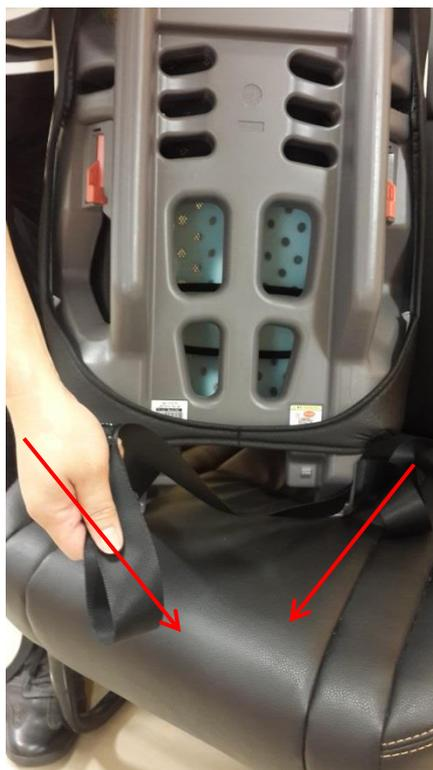
步驟八、收納安全帶調解金屬(須將坐墊布及內墊拿掉，收納槽在座位上方)
